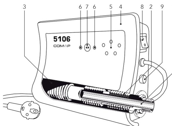
1. Chambre de traitement en polyéthylène avec raccords laiton
