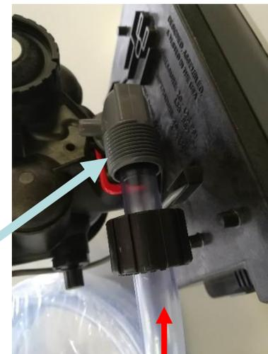
Tube PE seulement (12x16) ou autre suivant les modèles d'adoucisseurs)
